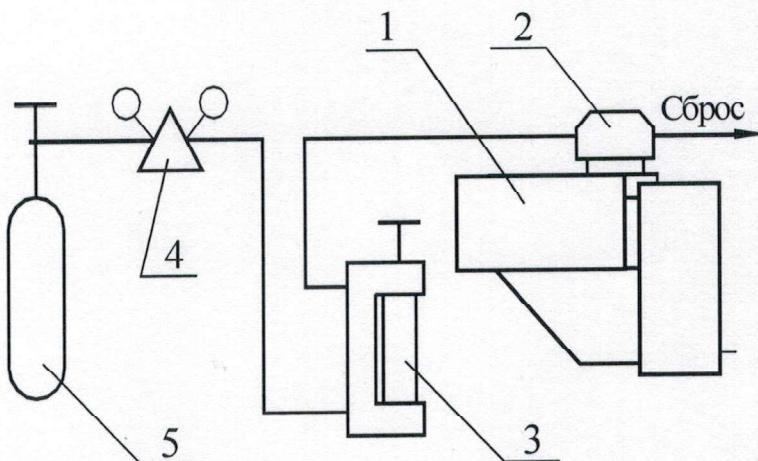
1 – преобразователь; 2 – насадка; 3 – ротаметр РМ-А-0,063, 4 – редуктор (регулятор расхода поверочной газовой смеси) ДПК 1,65; 5 – баллон с поверочной газовой смесью.
