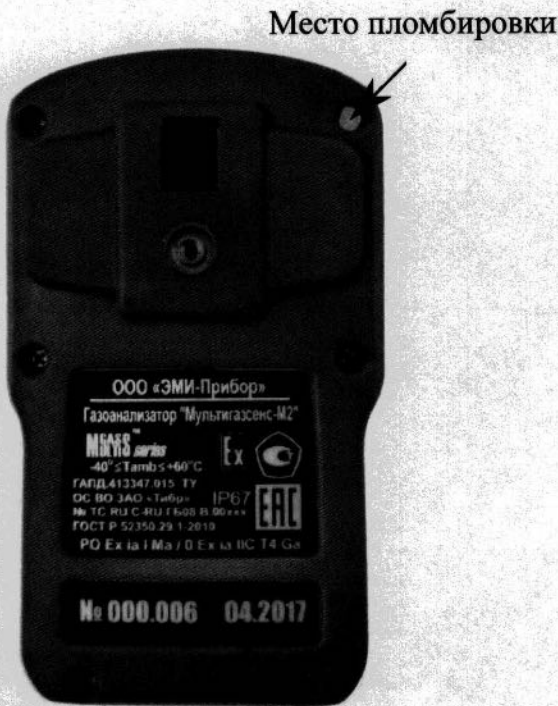
Рисунок 2 - Схема пломбировки от несанкционированного доступа МУЛЬТИГАЗСЕНС-М2
