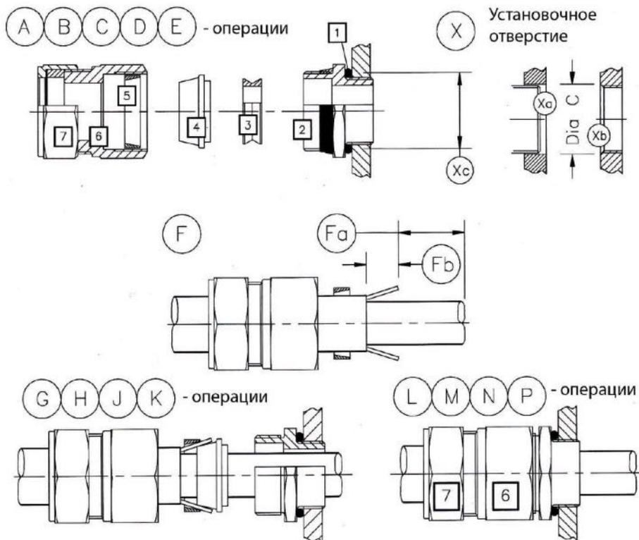
Рисунок А.4 – Сборочный чертеж кабельного ввода E3XBF/20S/M20
