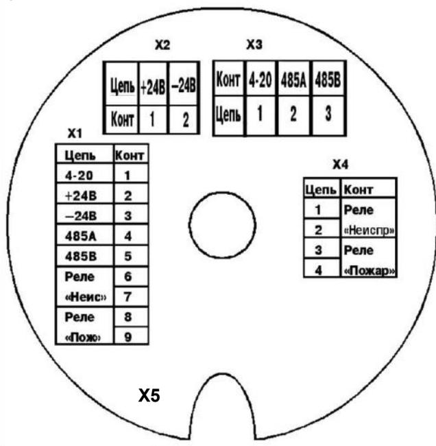
X1 – вилка WF9 для соединения с блоком опико-электронным:
