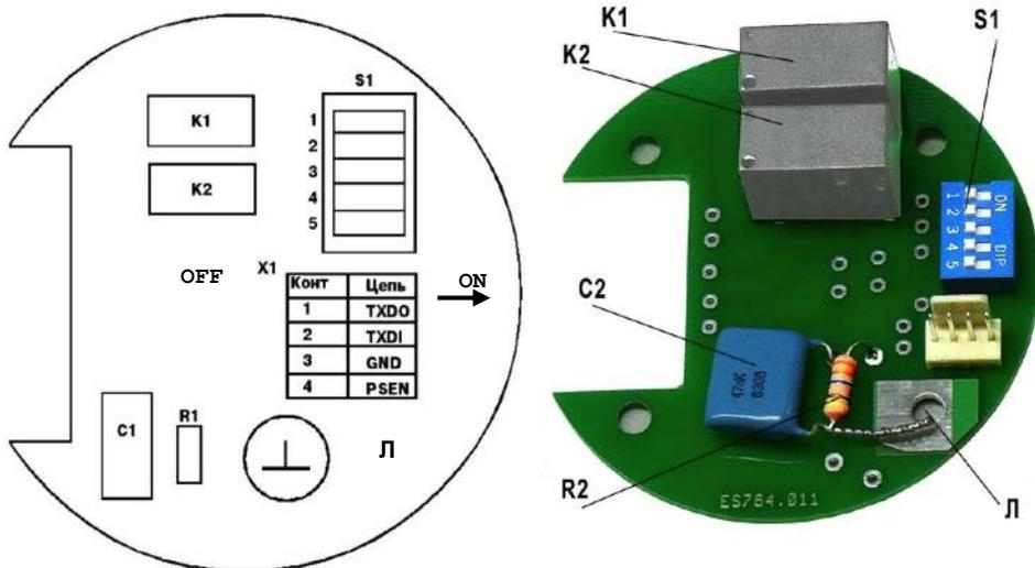
Рисунок А.8 – Расположение переключателя чувствительности (режим «Далеко»/ «Близко») и быстродействия (режим «Быстро»/«Медленно») на коммутационной плате извещателя.
